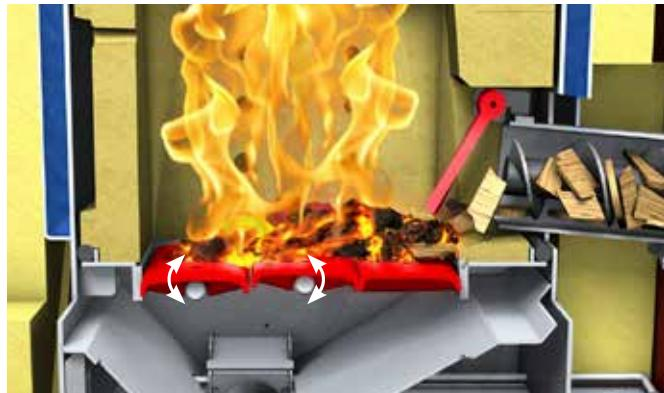
Videre er ristene i stand til å **presist justere brannlaget** for å sikre en homogen forbrenningsprosess.
