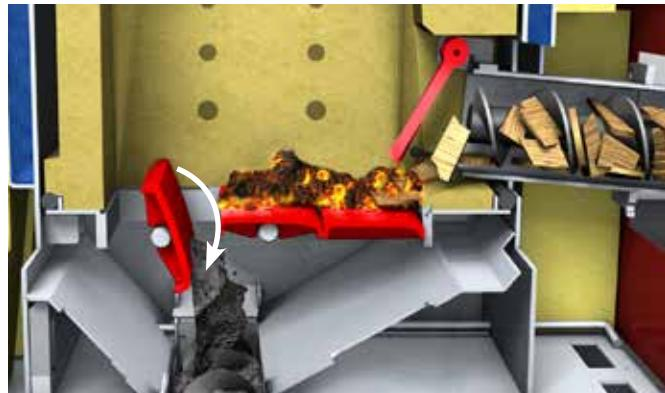
Hvis det brukes vanlig flis eller pellets åpnes bare den **bakre askerista**. Asken faller til bunns i askeskruen, og glør blir igjen i brennkammeret.
